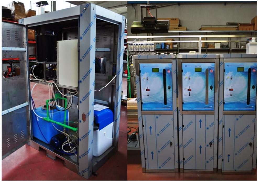
china è controllata dal titolare dell'impianto tramite una app che consente l'intervento del tecnico da remoto. Per evitare che le macchine siano accidentalmente sprogrammate, l'accesso al PLC è consentito solo ai tecnici. Le funzioni più semplici possono essere eseguite dal cliente direttamente da tastierino: la versione standard con-
